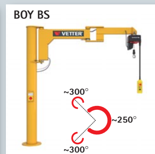
Typenbezeichnung: BOY BS Tragfähigkeit: 63 – 250 kg Ausladung: 2.000 – 4.000 mm
