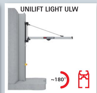
Typenbezeichnung: UNILIFT LIGHT ULW Tragfähigkeit: 100 kg 1 Ausladung: 1.835 - 2.835 mm Schwenkbereich: nominal 180°
